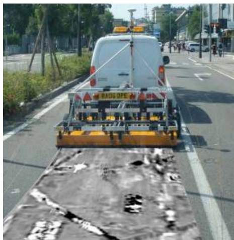
Figura 3. Sistema IDS Stream a quattro banchi, per un totale di 38 canali attivi, montato su carrello trainato da furgone durante la scansione di Via Torino.
